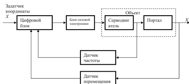
**Рис. 2. Структурная схема системы автоматического управления движением подложкодержателя вдоль оси X**
