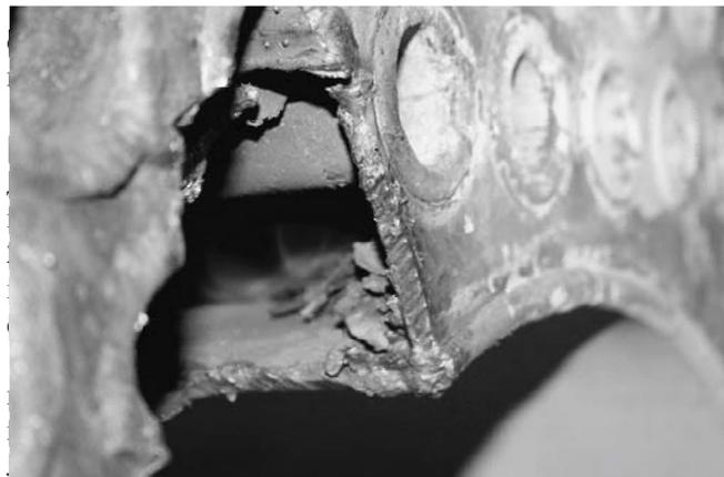
Рис. 2. Отложения в котле в зоне разреза
