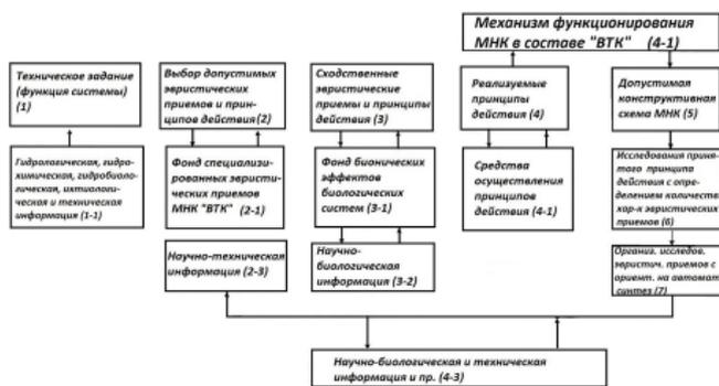
Рис. 1. Блок-схема синтеза КИЗ по созданию МНК водозаборного сооружения в составе ВТК
