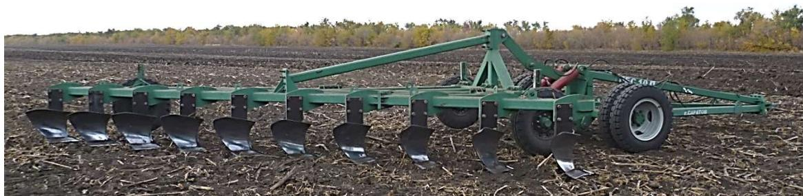
**Рис. 1. Общий вид прицепного плуга ПБС-10П**
