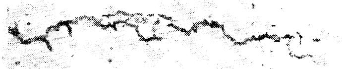
Рис. 1. Микро- и макроветвления трещины под микроскопом с увеличением  $\times 70$
