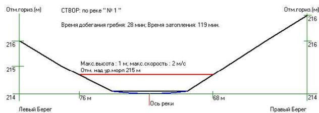
Рис. 10. Продольный профиль по створу 1 (0,5 км от створа гидроузла)
