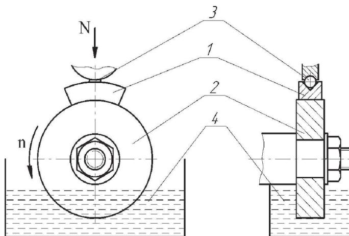
Fig. 3. Scheme «roller – pad»: 1 – pad; 2 – roller; 3 – pad retainer; 4 – lubricating medium
