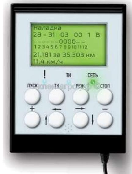
*Рисунок 3 – Пульт управления сеялкой Клен-1,5
