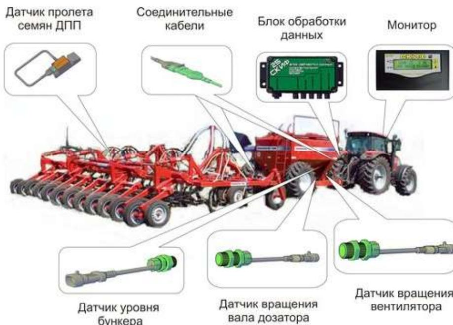
**Рисунок 4 – Система контроля высева «СКИФ Т-04»**
