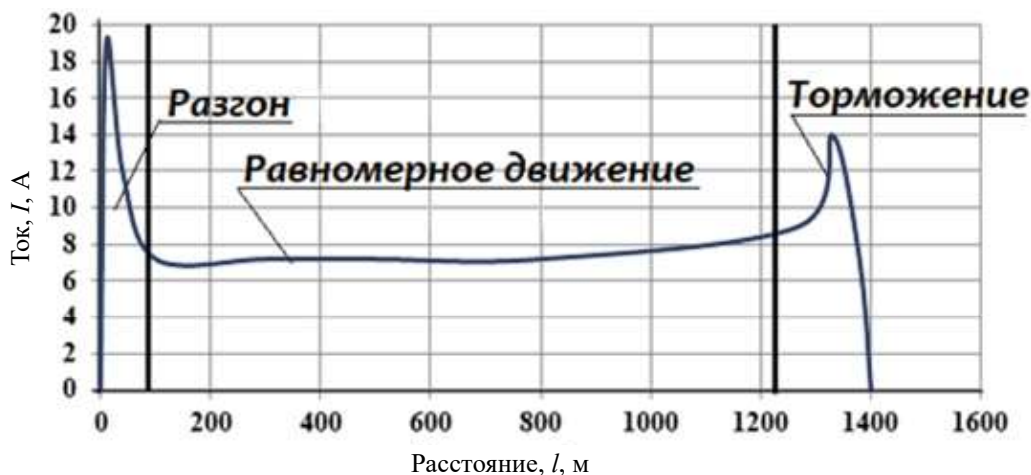
Рисунок 2 – График зависимости тока электропривода от времени при движении трактора Т-16М
